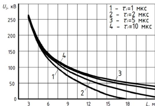
Рис. 2. Зависимость напряжения в рассматриваемой точке ЗУ на расстоянии  $L$  от точки ввода тока молнии  $I = 20 \text{ кА}$  при разных значениях длины его фронта
