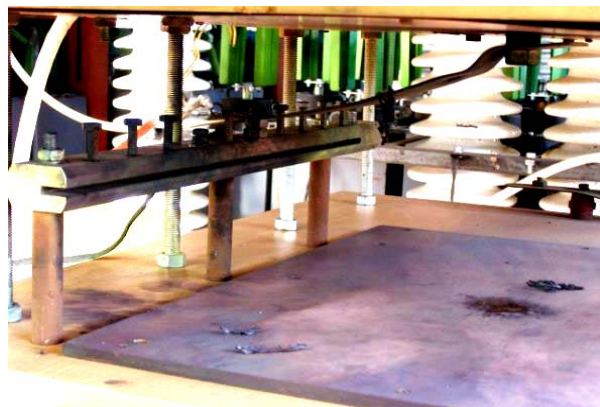
Рис. 6. Внешний вид рабочего стола ГТМ после ЭВ токонесущих частей испытываемого в его сильноточной разрядной цепи ОО длиной 0,55 м радиочастотного кабеля марки РК 75-4-11 с ПЭТ изоляцией и включенным в разрыв разрядной цепи высоковольтного генератора суммарным сечением его медной жилы и медной оплетки, равным (S_{C1} + S_{C2}) \approx 2,85 \text{ мм}^2 ( I_{mp1} \approx 184,7 \text{ кА} ; \delta_{CC1} \approx |I_{mp1}|/(S_{C1} + S_{C2}) \approx 64,8 \text{ кА/мм}^2 ) [1, 14]
