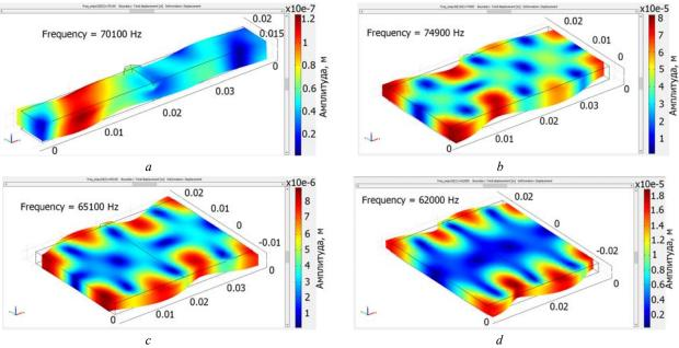
Рис. 4. Некоторые из результатов моделирования амплитудных колебаний пьезоэлемента линейного двигателя с разными отношениями ширины к длине пластины: a - K = 0.125; b - K = 0.5; c - K = 0.875; d - K = 1.125
