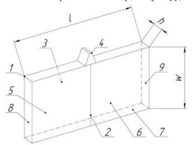
Рис. 1. Пьезокерамическая пластина линейного пьезокерамического двигателя компании Physik Instrumente
