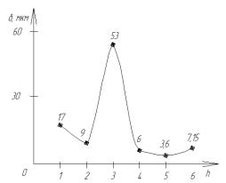
Рис. 7. Зависимость амплитуды колебаний толкателя от толщины пьезокерамической пластины h при параметре  $K=0.5=\mathrm{const}$
