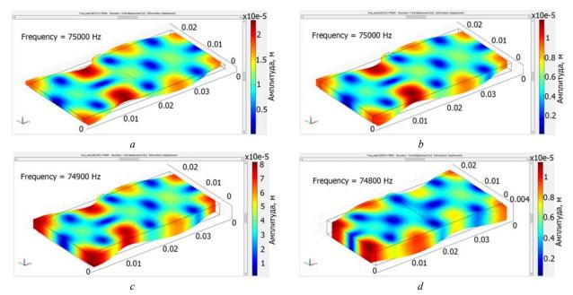
Рис. 6. Некоторые из результатов моделирования амплитудных колебаний пьезопластины линейного двигателя с разной толщиной при постоянном параметре K = 0.5: a - h = 1; b - h = 2; c - h = 3; d - h = 4
