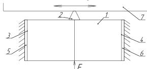
Рис. 3. Схематическое представление экспериментального линейного пьезоэлектрического двигателя
