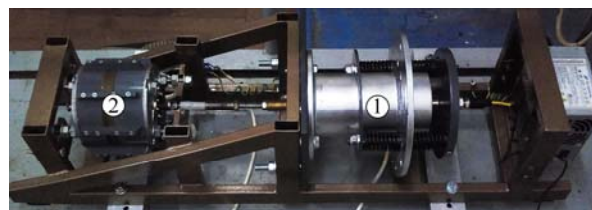
Рис. 2. Конструкція дослідної (а) та навантажувальної (б) машин
