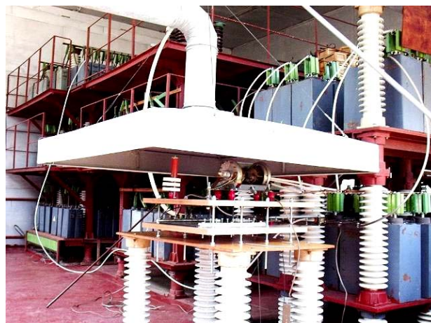
Рис. 1. Общий вид мощного высоковольтного сильноточного генератора тока искусственной молнии типа УИТОМ-1 (на переднем плане находится рабочий стол с высоковольтным трехэлектродным воздушным управляемым коммутатором со стальными электродами на напряжение \pm 50 кВ и импульсный синусоидальный ток молнии амплитудой до \pm 220 кА, испытываемым образцом обшивки летательного аппарата и системой воздушной вытяжки, а на заднем плане – отдельные высоковольтные генераторы импульсных токов для соответствующих компонент тока A , B , C , C^* и D ) [11]
