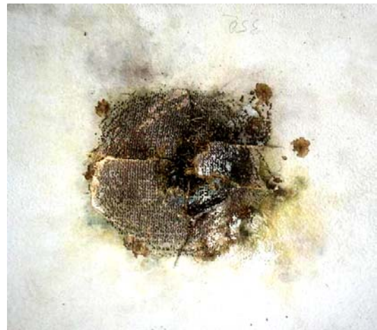
Рис. 8. Общий вид зоны повреждения диаметром до 100 мм со сквозным прожогом в опытном листовом образце толщиной 3 мм композиционной обшивки самолета, испытываемого в сильноточной цепи мощного ГТМ типа УИТОМ-1, при прямом воздействии на него нормированной по [7, 8] импульсной A -компоненты тока искусственной молнии [10]
