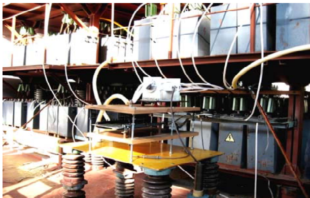
Рис. 9. Общий вид мощного высоковольтного сильноточного генератора тока искусственной молнии типа ГТМ-10/350 (на переднем плане находится его рабочий стол с размещенным сверху на нем управляемым высоковольтным трехэлектродным воздушным коммутатором с графитовыми электродами на напряжение \pm 50 кВ и импульсный аперидический ток молнии амплитудой до \pm 220 кА и испытываемым образцом кабельно-проводниковой продукции, а на заднем плане – электротехнические элементы зарядно-разрядных цепей его отдельных высоковольтных генераторов импульсных токов ГИТ-1, ГИТ-2, ГИТ-3 и ГИТ-4) [19]
