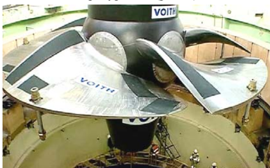
Рис. 4. Общий вид новой современной мощной поворотной лопастной гидротурбины в момент ее установки на ГЭС [7]
