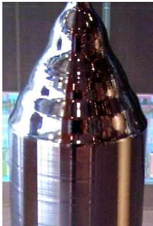
Рис. 12. Общий вид выращенного в вакууме технологами-материаловедами монокристаллического кремния [18]
