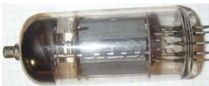
Рис. 4. Общий вид современной вакуумной радиолампы [7]
