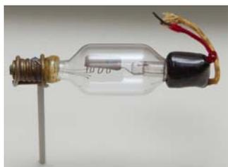
Рис. 1. Общий вид триода, созданного Ли де Форестом [5, 6]
