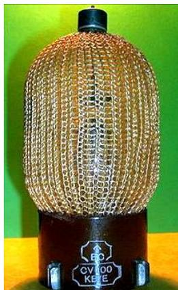
Рис. 6. Общий вид мощного тригatronа типа CV100 [11]
