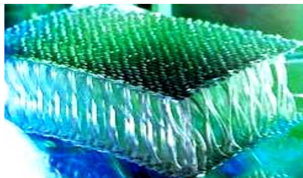
Рис. 2. Общий вид фрагмента оригинальной стеклоткани типа Parabeam 3D Glass fabric, состоящей из двух сотканых горизонтально размещенных параллельных стеклопластин, связанных друг с другом вертикальным стекловорсом, и образующей так называемую «сэндвич-стеклоструктуру» [6]
