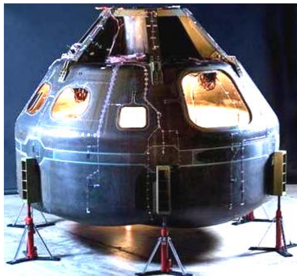
Рис. 5. Общий вид орбитального отсека нового космического корабля Liberty (США), выполненного на 90 % из полимерных композитов и предназначенного для многократной доставки астронавтов и научных грузов на борт МКС [17]
