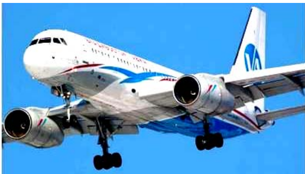
Рис. 3. Общий вид среднемагистрального пассажирского самолета типа Ту-204 (РФ, 1990-е годы), в котором до 25 % всех деталей планера было выполнено из композитов [14]
