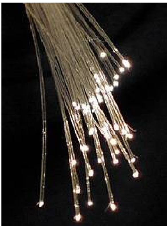
Рис. 16. Внешний вид фрагмента пучка оптических волокон с кварцевыми нитями в защитной оболочке, эффективно передающих на дальние расстояния световые импульсы [22]
