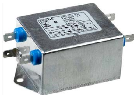
Рис. 19. Общий вид сетевого фильтра подавления МЭМП типа B84115-E-V30 (ток – 6 А; напряжение – 250 В; частота – 50/60 Гц; изготовитель – фирма «Epcos», Германия) [46]
