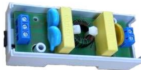
Рис. 20. Внешний вид ЕМІ-фильтра (с открытой пластмассовой крышкой изоляционного корпуса ФНЧ) для защиты от импульсных помех устройств автоматики и управления (ток – 10 А; напряжение – 260 В; частота – 50/60 Гц) [47]
