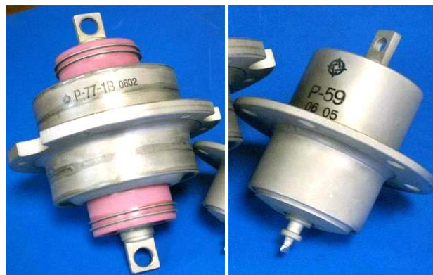
Рис. 7. Внешний вид мощных грозозащитных герметичных разрядников, применяемых при защите радиотехнической аппаратуры от перенапряжений, вызванных прямым ударом в нее молнии (слева-направо: типа P-77-1В и типа P-59) [36]
