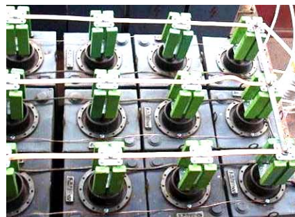
Рис. 25. Внешний вид фрагмента мощного высоковольтного ЕНЭ одномодульного исполнения на номинальное напряжение \pm 50 кВ и номинальную запасаемую электрическую энергию 420 кДж с его параллельно включенными конденсаторами типа ИК-50-3 в количестве 112 шт. и жестко установленными на их всех высоковольтных выводах защитными высоковольтными объемными постоянными графито-керамическими резисторами типа ТВО-60-24 Ом [49]
