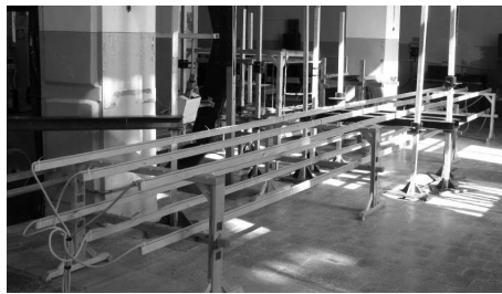
Рис. 1. Внешний вид макет трехфазного токопровода
