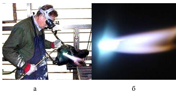
Рис. 8. Газовая пайка (сварка) металлов (а) при помощи ацетилено-кислородного пламени (б), имеющего на расстоянии 3 мм от своего ядра температуру около 3150 °С [13]
