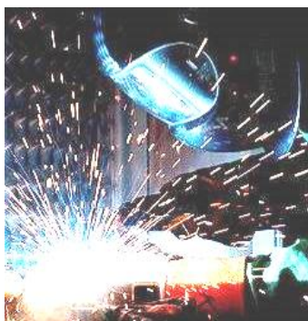
Рис. 19. Внешний вид ослепительно яркой рабочей зоны при электродуговой сварке металлов, сопровождающейся радиальным разбрызгиванием мелких капель металла [3]
