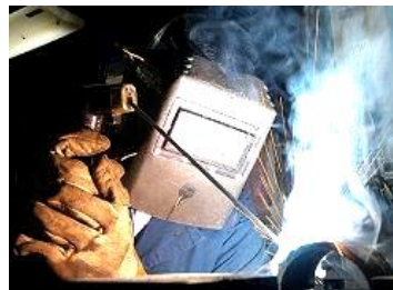
Рис. 17. Электродуговая ручная сварка покрытым электродом, ставшая широко распространенным видом сварки [22]
