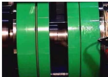
Рис. 14. Компактное российское оборудование для соосной сварки вращающихся металлических изделий трением [3]
