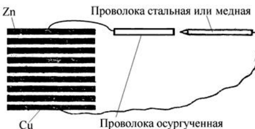
Рис. 2. Схема опытов В.В. Петрова, приведших к открытию им в 1802 году в России электрической вольтовой дуги [8]
