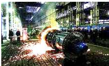
Рис. 13. Общий вид российского оборудования для стыковой сварки стальных труб большого диаметра непрерывным оплавлением, находящегося в цеху Псковского завода по производству труб Ø 1420 мм для нефти-и газопроводов) [3]
