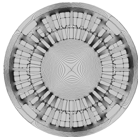
Рис. 11. Магнітне поле в генераторному номінальному режимі роботи
