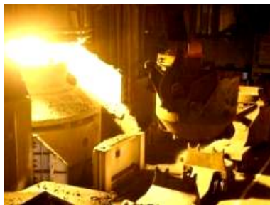
Рис. 8. Внешний вид современного кислородного конвертера для производства стали и других металлов [12]
