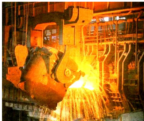
Рис. 9. Внешний вид современной мартеновской печи [4]
