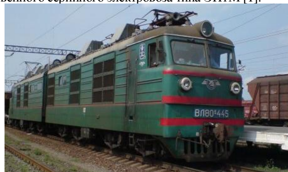
Рис. 8. Советский электровоз типа ВЛ80Т, работающий от переменного тока частотой 50 Гц и напряжением 25 кВ [6]
