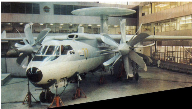
Рис. 44. Современный российский многолопастный самолет ЯК-44 с винтовентиляторными двигателями типа Д-27 [19]
