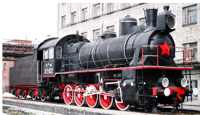
Рис. 7. Отечественный паровоз серии Э, оказавшийся самым массовым в мире локомотивом с паровой силовой тягой [4]
