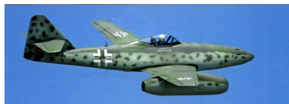
Рис. 39. Первый немецкий серийный турбореактивный истребитель-бомбардировщик " Мессершмитт " типа Me-262, выпущенный в 1944-1945 гг. в количестве до 1300 шт. [1, 18]
