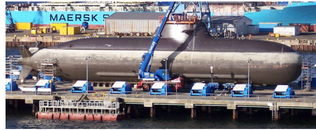
Рис. 33. Современная германская подводная лодка класса U-212 с силовой энергоустановкой на водородных топливных элементах [13]
