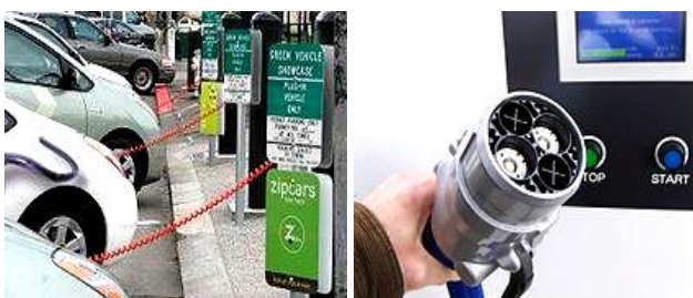
Рис. 15. Внешний вид современной электростанции (слева) в США (г. Сан-Франциско) и переносной вилки (справа) для заряда аккумуляторов электромобиля [8]
