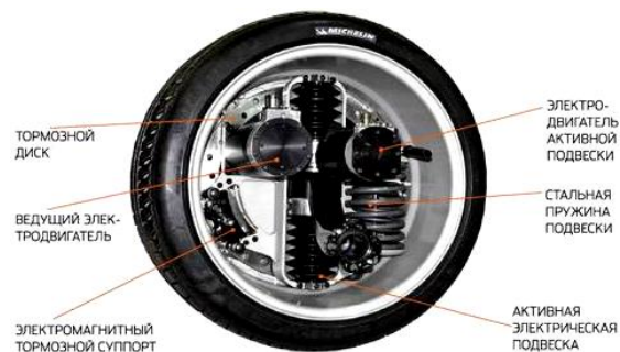
Рис. 13. Внешний вид современной автомобильной системы "электромотор-колесо", применяемой в электромобилях [8]
