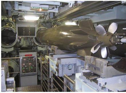
Рис. 31. Торпедный отсек современной французской атомной подводной лодки класса "Le Redoutable" [13]
