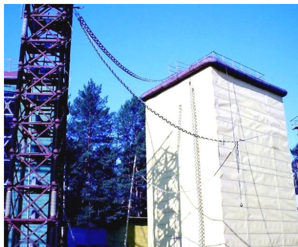
Рис. 4. Общий вид генератора для формирования на активно-индуктивной нагрузке стандартного коммутационного аperiodического импульса напряжения временной формы 205/1900 мкс амплитудой U_m до 2 МВ (слева видна изоляционная опора с нагрузочной емкостью C_H \approx 13,3 нФ, к верхнему потенциальному электроду которой подсоединены формирующий R_\phi \approx 4,28 кОм и токоограничивающий R_T \approx 4,59 кОм резисторы)
