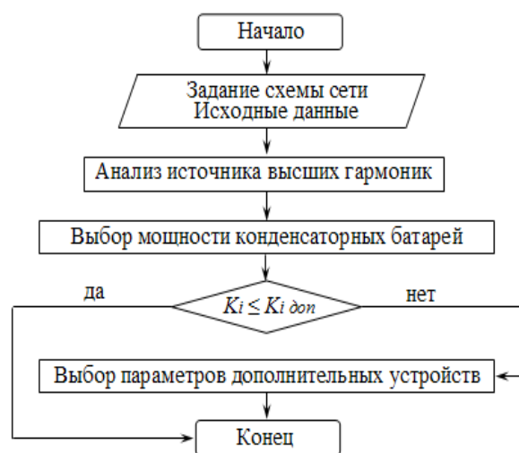
Рис. 2. Алгоритм выбора структуры системы компенсации реактивной мощности, где K_i – коэффициент перегрузки, K_i – допустимый коэффициент перегрузки
