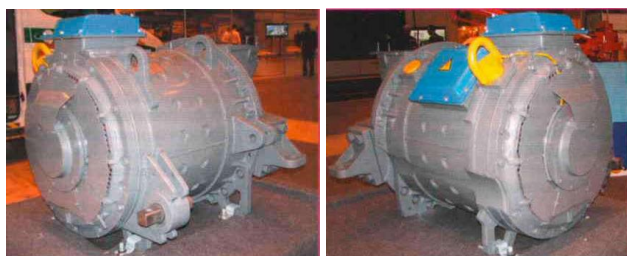
Рис. 1. Асинхронный тяговый электродвигатель ДТА-1200А с короткозамкнутым ротором
