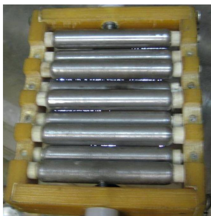
Рис. 2. Многозазорный разрядник с цилиндрическими электродами. Вид разрядника в проекции на плоскость: а – параллельную направлению развития разряда; б – перпендикулярную направлению развития разряда; в – фотография разрядника во время работы, где видно, что разряды перемещаются вдоль всей длины электродов
